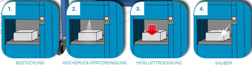
1. BESTÜCKUNG      2. HOCHDRUCK-SPRITZREINIGUNG      3. HEIßLUFTTROCKNUNG      4. SAUBER
